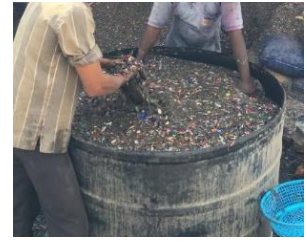
Proceso de separación de hundimiento y flotación con escamas de plástico
