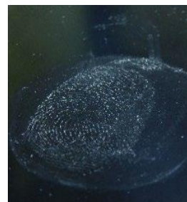
Depósito blanco causado por la reacción de acetona con PC
